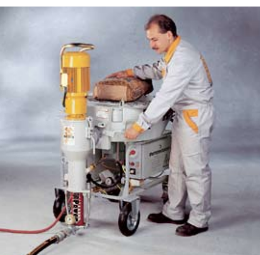
Spremnik materijala i cijev mješalice su međusobno odvojeni. Kada se otvori zapor, suhi materijal ulazi u cijev za miješanje.
